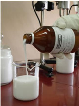
Las suspensiones concentradas constan de un ingrediente activo sólido en forma de cristales o polvo suspendido en un líquido, más otras sustancias que permiten mezclarse con agua para su aplicación. Las ventajas y desventajas son similares a los polvos humedecibles.
