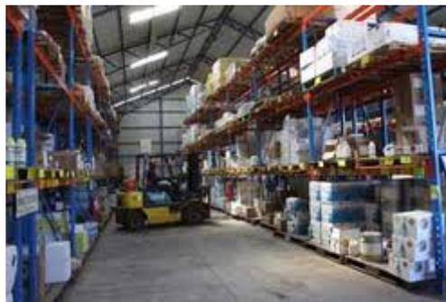
El almacén debe tener buena iluminación y no puede estar construido de madera u otros materiales que lleven a cabo combustión. El piso debe ser de cemento y no de madera o tierra.
