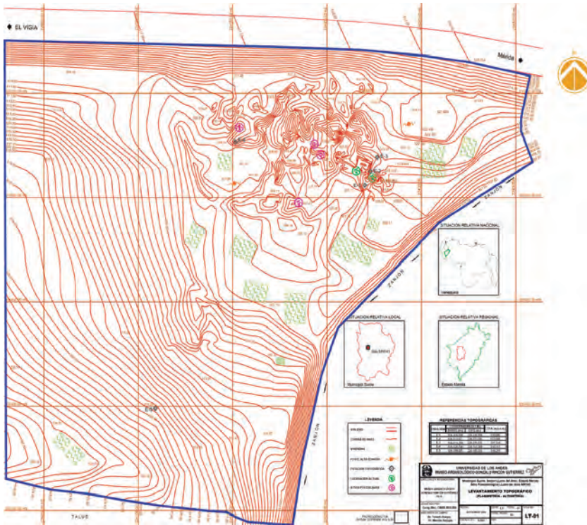
Levantamiento topográfico del sitio Paleoarqueológico del Llano del Anís. Los puntos rosados, los afloramientos de megafauna, en el punto verde la excavación. Elaborado por: Omar Molina.
