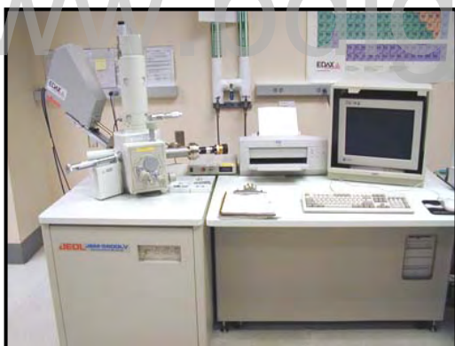
Microscópio electrónico de barrido y su especificación técnica
