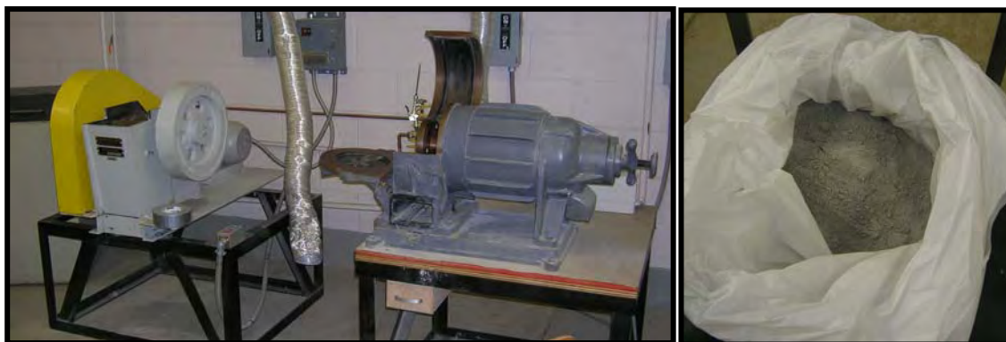
Trituradora, pulverizadora y fracción obtenida
