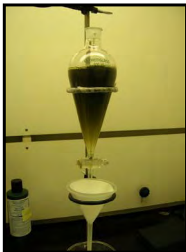
Proceso de separación mineral con líquidos pesados
