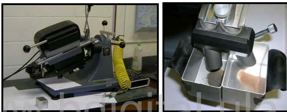
Separador magnético y envases contentivos de la fracción magnética y de circones.
