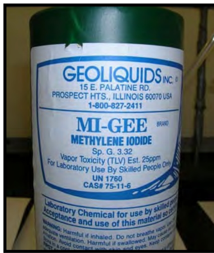
Proceso de separación mineral con líquidos pesados
