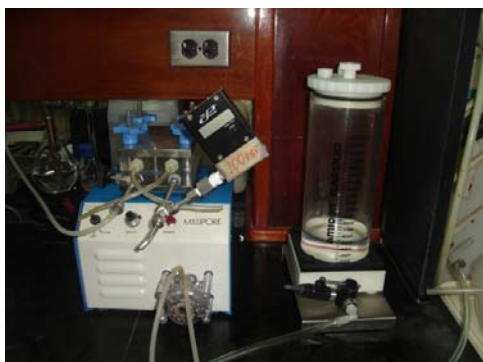
Figura VII.13. Sistema de bombeo y filtración MINITAN.
