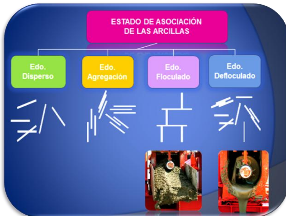
Gráfico N° 29. Estado floculado de las partículas de arcilla.
