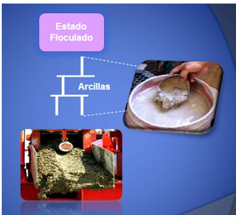
Gráfico N° 28. Estado floculado de las partículas de arcilla. Fuente. Elaboración propia.
