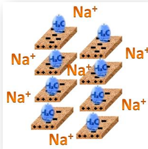
Gráfico N° 26. Estado disperso de las partículas de arcilla. Fuente. Elaboración propia.
